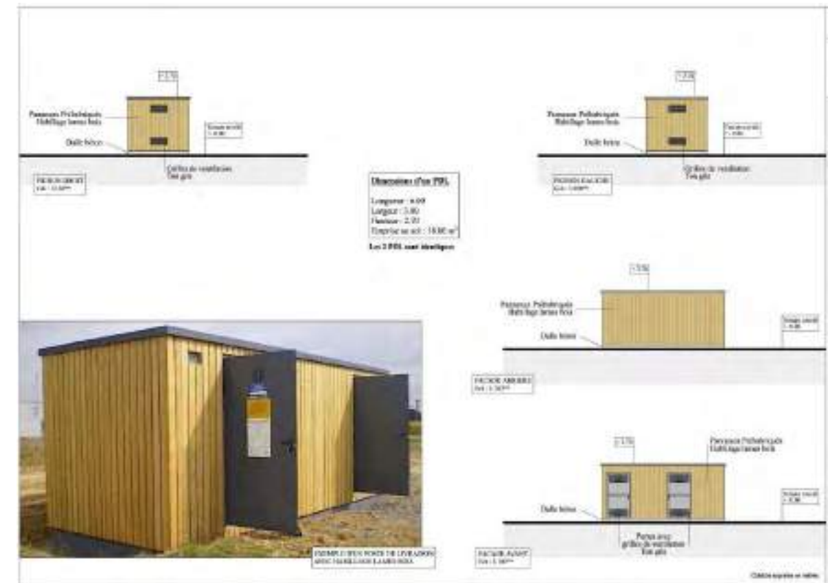
Figure 23 : Exemple d'un poste de livraison HTA/BT
