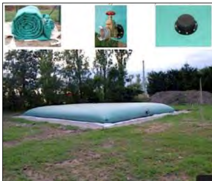
Figure 30 : Exemple de citerne souple (Source : ABOWIND)
