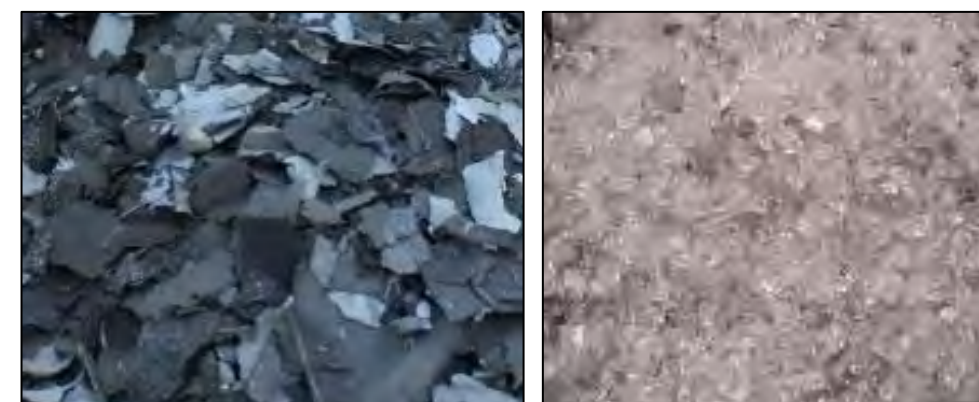
Figure 33 : Fragments de silicium et granules de verre (Source : PV CYCLE, photovoltaïque.info)
